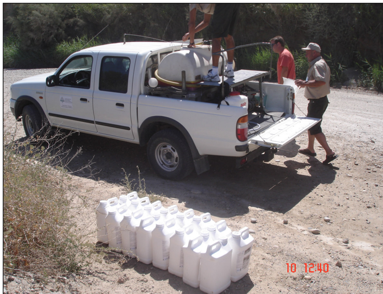
Foto 13: Càrrega del Bti al dipòsit muntat a la part posterior del vehicle tot terreny.
