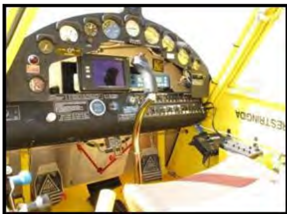
Equipament de l'avió amb el sistema diferencial GPS. Interior de la cabina.
